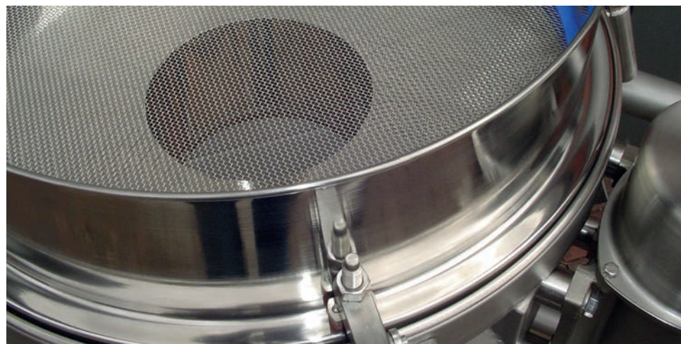
Afb. 3 Een zeefdek voor de controlezeving van melkpoeder
