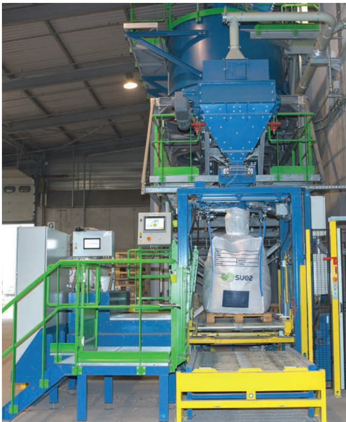
Afb. 1 De 'Apollo' bigbagvullijn van Bascules Robbe bij Valomet in Gent
