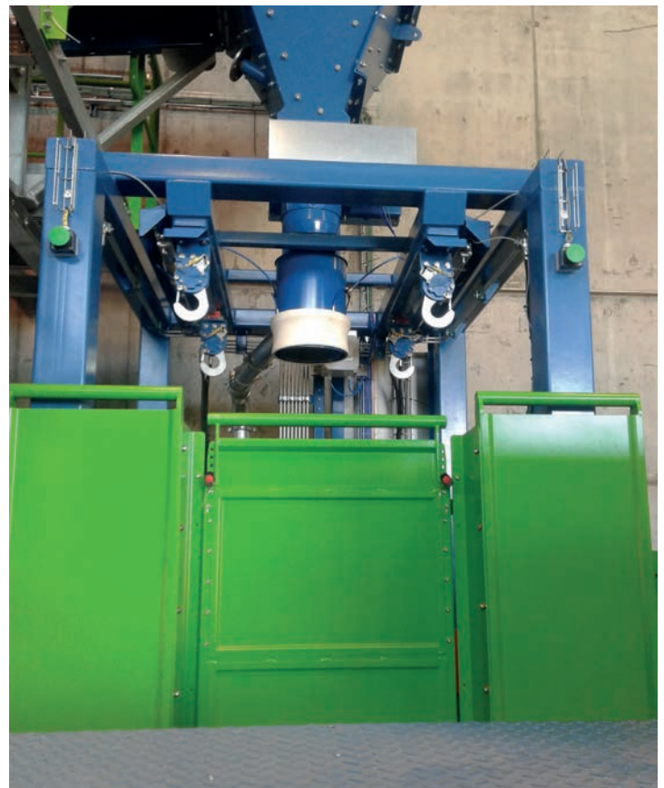
Afb. 2 Het bordes met de mee-verende borstwing direct voor het vulstation
