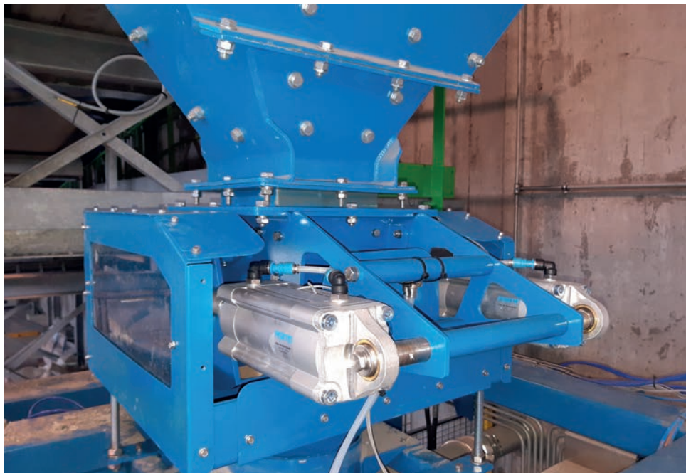
Afb. 3 Bascules Robbe heeft voor een nauwkeurige afvulling van de metaaldeeltjes een speciale helmklep ontwikkeld
