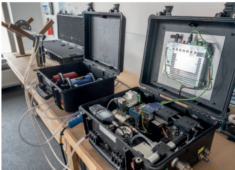
Afb. 2 Meetset voor isokinetische kalibratie van een stofemissie-meter; v.l.n.r. de meetlans, de luchtconditionering en het daadwerkelijke meettoestel
