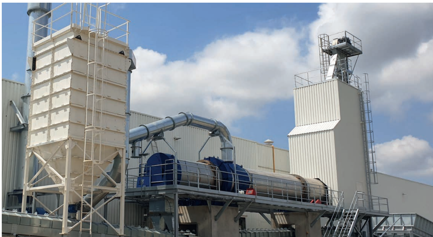
Afb. 1 Lessine koeldroger met de tweedelige buis-trommel (links koelen, rechts drogen)
