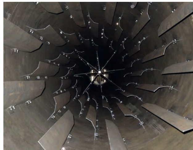
Afb. 2 Schoepen in de buistrommel mengen en transporteren het te drogen product
