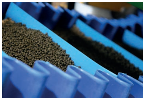
Transportbanden kunnen worden voorzien van golfranden, meenemers en stuursnaren
