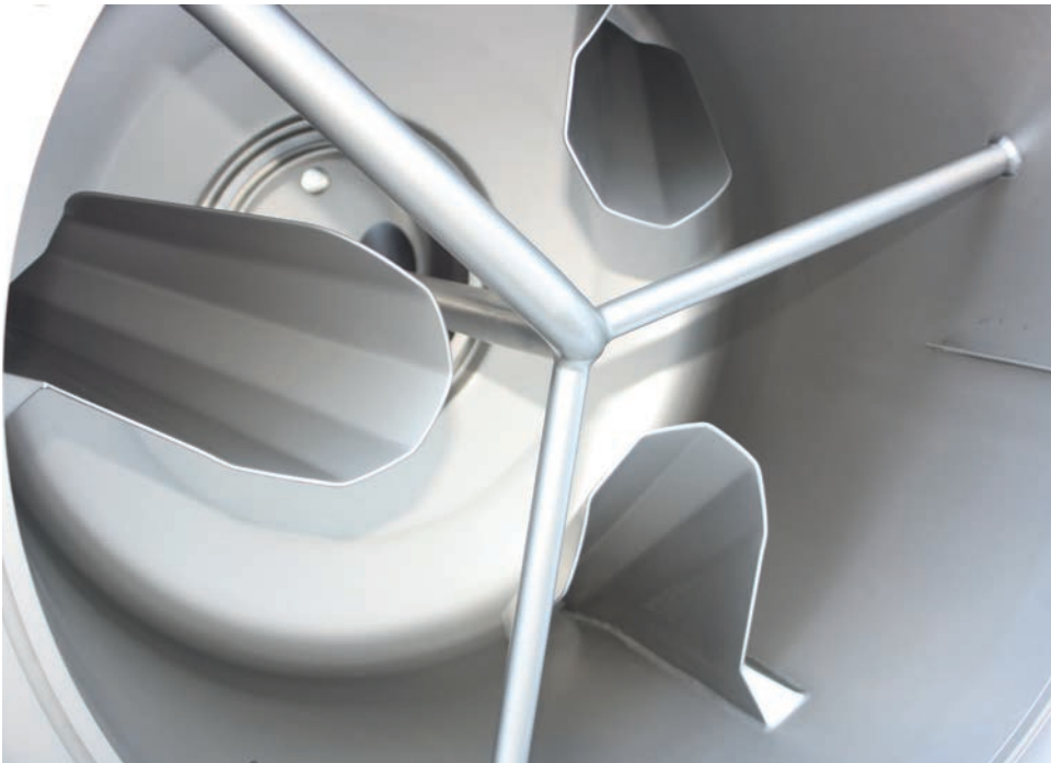
Afb. 2 Inkijkje in mengtrommel met de toe- en afvoerleidingen voor het medium naar de mantel
