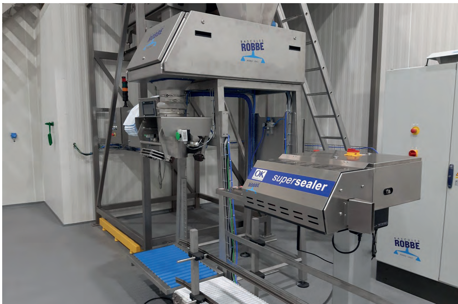
Afb. 1 Zakkenvulmachine met 'Supersealer' sluitstation
